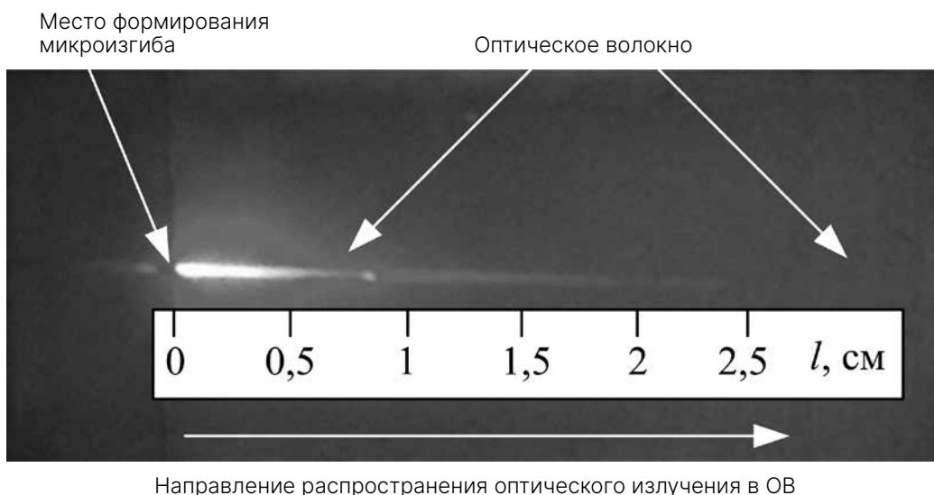
Рисунок 3. Фотография микроизгиба оптического волокна G655, по которому распространяется оптическое излучение с длиной волны 1310 нм
